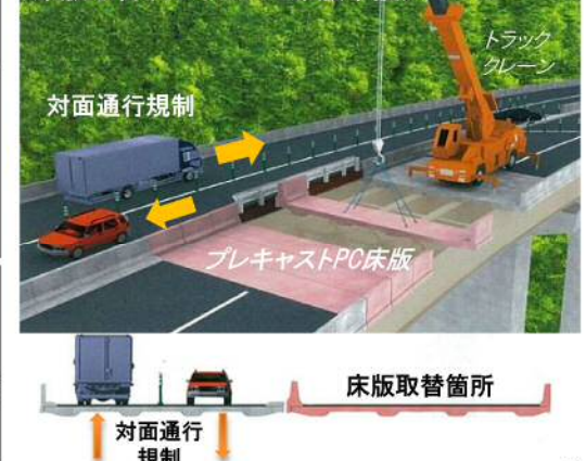
床版取替(プレキャストPC床版架設)イメージ
